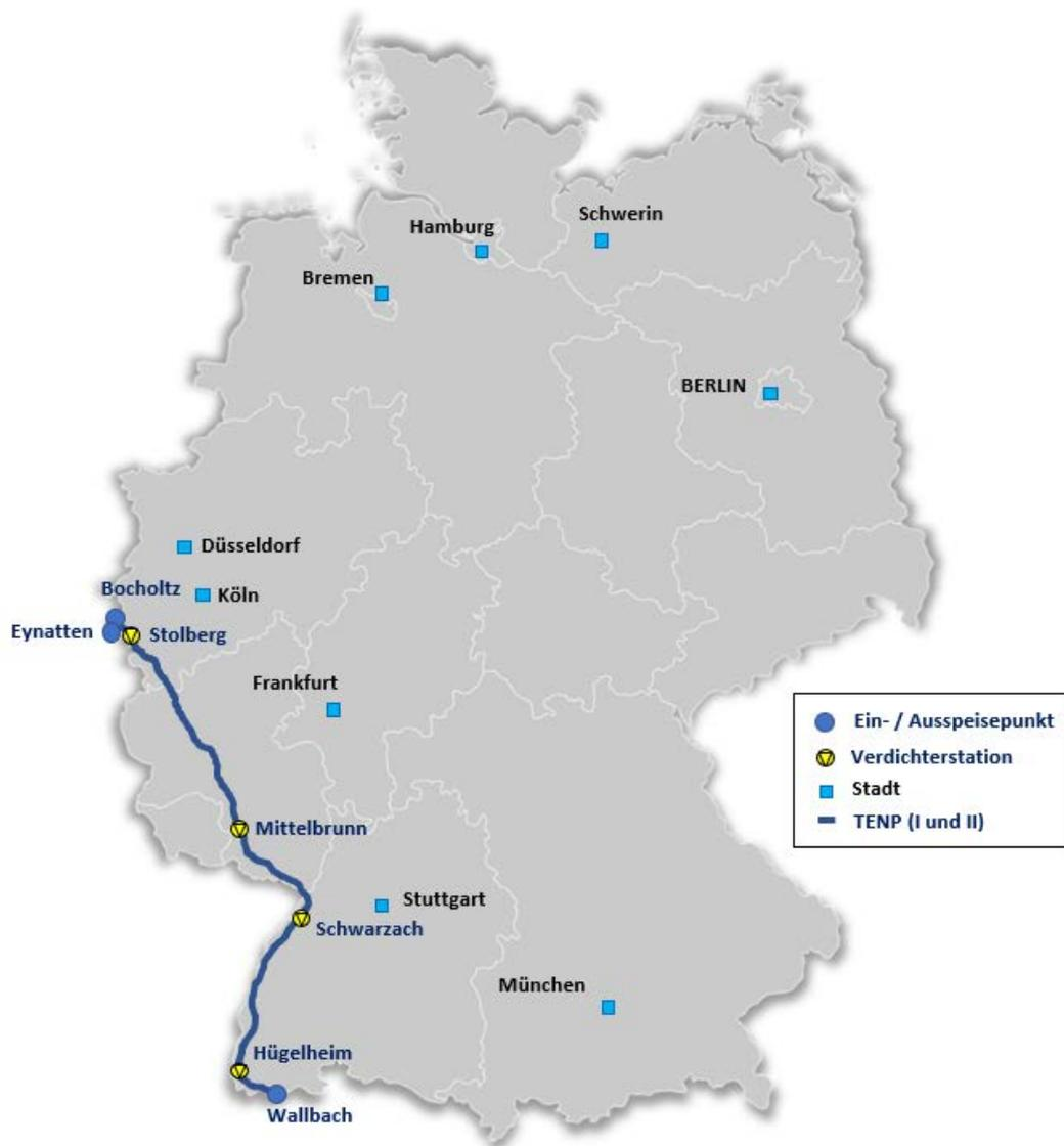
Abbildung 3: Der Verlauf der TENP-Leitung, Ein- und Auspeisepunkte, sowie die Verdichterstationen entlang der Leitung.
